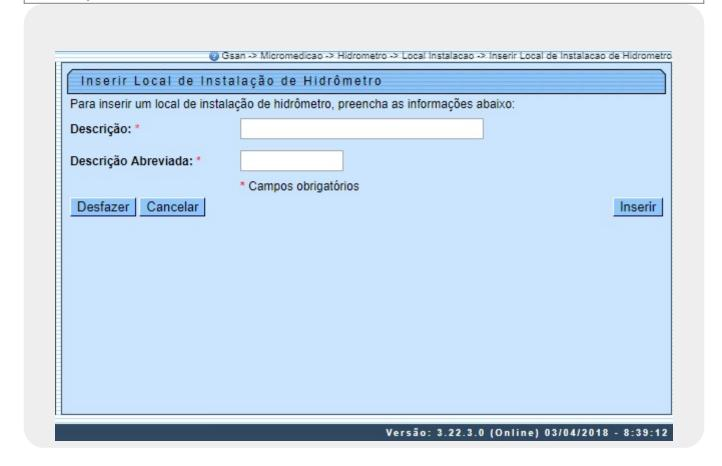
Acima, informe, obrigatoriamente, a **Descrição** do local de instalação com, no máximo, 20 caracteres, e a **Descrição Abreviada** com, no máximo, 5 caracteres. Depois, clique no botão
