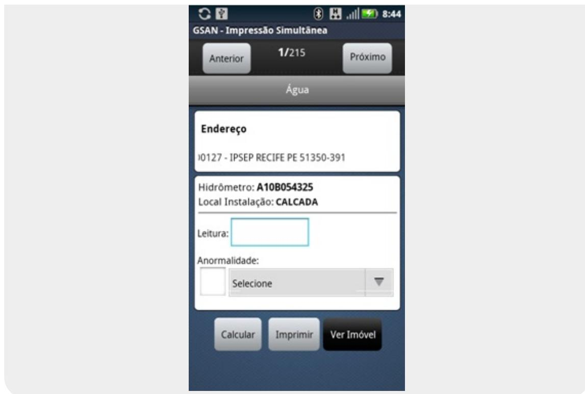
Caso o imóvel seja medido, o sistema exibe a aba de **Hidrômetro** (de Água ou de Poço) do primeiro registro. Essa aba mostra o endereço, o número e o local de instalação do hidrômetro, os campos de leitura e anormalidade e os botões **Calcular**, **Imprimir** e **Ver Imóvel**. Caso o imóvel seja não-medido, o sistema exibe a aba de **Conta**, com informações sobre os consumos e valores de água e esgoto daquele imóvel, por exemplo:
