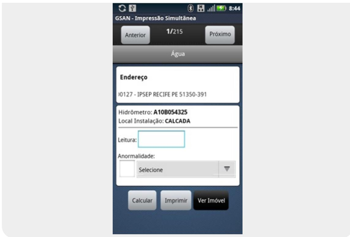
Caso o imóvel seja medido, o sistema exibirá a aba de **Hidrômetro** (de Água ou de Poço) do primeiro registro. Essa aba mostra o endereço, o número e o local de instalação do hidrômetro, os campos de leitura e anormalidade e os botões **Calcular**, **Imprimir** e **Ver Imóvel**.
